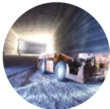
**Соль добывается** подземным способом камерной системы отработки на глубине 300 м. Камеры отработываются послойно при помощи горнопроходческих комбайнов, отбивающих соль. Доставка соли к стволам осуществляется самоходными вагонами и конвейерами. Отработанные камеры представляют собой комнаты с потолками тридцатиметровой высоты, шириной 30 м и длиной 500 м, на стенках которых комбайн оставляет фрезами рисунок с красивым выпуклым узором.
